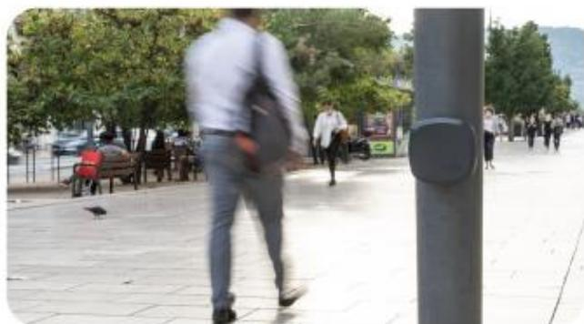
*Le capteur PYRO<sup>EVO</sup> intégré dans la PYRO-Box<sup>EVO</sup> est un système autonome, compact et mobile pour compter les personnes. Conçu pour l'extérieur, en environnement urbain il permet la mesure des flux sur les trottoirs ou voies partagées.*
