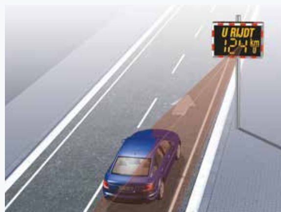
Voorbeeld van een Traffichex snelheidsinformatiebord in werking.
