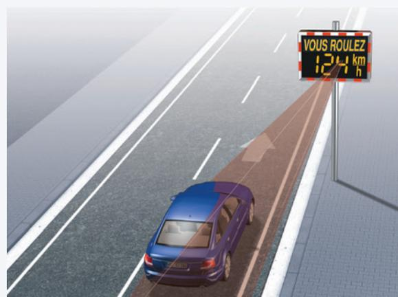
Exemple d'utilisation d'un radar préventif en fonctionnement.
