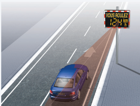
Exemple d'utilisation d'un radar préventif en fonctionnement.
